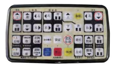
自动打拔设定 打桩:自动+夹头下 拔桩:自动+夹头下
